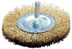
RASPALL ABRASIU DISC BDER Acer llautonat. Espiga 6 mm 0,30 mm. Eliminació de rovells, pintures i adherències en reixes, balcons, etc. Poliment de peces. 1612927 50 mm. 1613129 100 mm.
