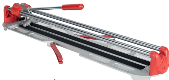
TALLADOR MANUAL CERÀMICA STAR 63 1010524 Amb separador mòbil. Amb rodeta de 6mm inclosa. Base amb efecte amortidor. 63 cm de longitud de tall. Gruix de tall 12 mm.
